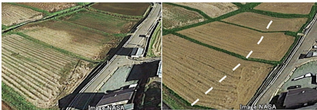
図3: 2015年12月18日の3D画像（左）と2016年4月15日の3D画像（右）。右図の白色に沿って凹地が認められる。ほぼこの位置に、4月16日の地震により地表断層が現われた。いずれの画像データも、Google Earth Proを用いて、NASA、CNES/Astriumより得られた。上下方向に3倍拡大されている。
