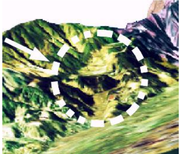
図3: 大川流域を下流側から見た3D図. 高さを3倍に拡大してある。白点線内が大川流域。中央の小丘は、左の矢印方向から滑り落ちたと思われる。
